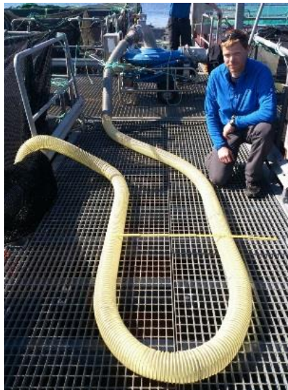
Figur 35 Slangen ble bøyd 180 grader med 70 cm diameter på sugesiden for å skape et bend.
