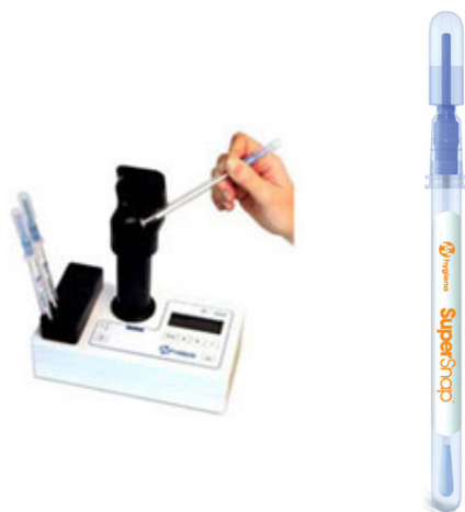
Bilde 1. Kommersielt tilgjengelig ATP-luminometer og svaber for prøvetaking.
