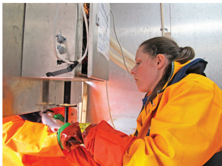
Foto: Kristine Bringslid, en av fire mastergradsstudenter som tok sin oppgave i prosjektet. Her måler hun fettinnhold i levende fisk (NIR), før fisken slippes ut igjen i merden
