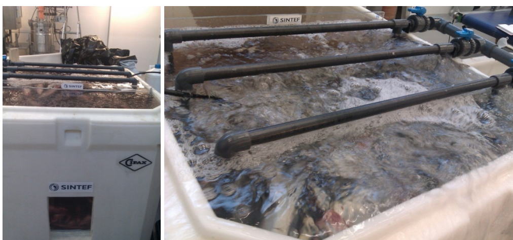
Figur 8: Vanskelig med visuell observasjon ved tilsetning av bobler. Observasjonsmuligheter i vannskorpen, og gjennom inspeksjonsluken i vegg (SINTEF, 2011)
