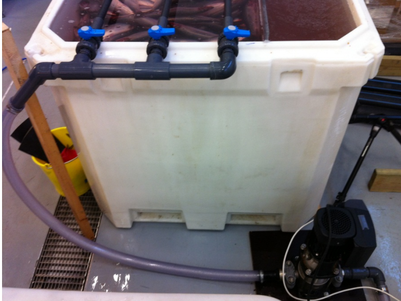
Figur 4: Forsøkstank med vannforsyning fra pumpe (SINTEF, 2011)
