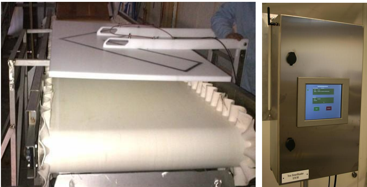
Figur 2. RFID antenne plassert over transportbeltet på fangstvekta på Norway Pelagic Selje, og kontrollskap med GPRS kommunikasjon montert på vegg.
