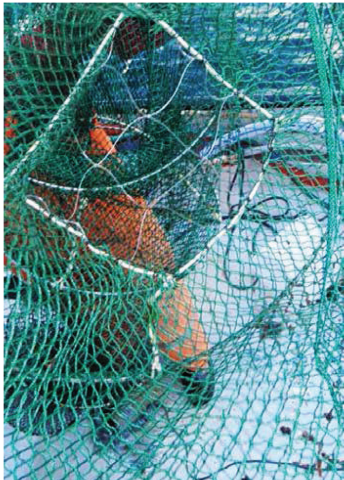
Bilde 2: For å hindre at større fisk, oter og krabber kommer inn i rusen ble det satt inn et notpanel i åpningen på første kalv. Maskestørrelse: 70 mm halvmaske er brukt her.
