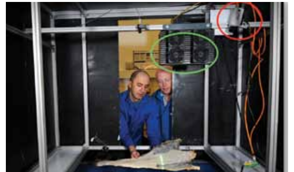
Slik ble maskinsynet gjennomført med 2D og 3D kamera i kombinasjon med laser.
