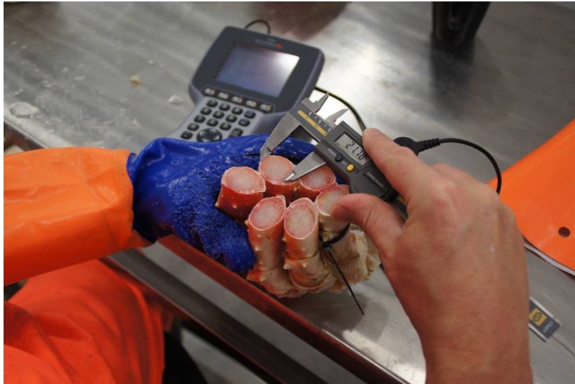
Bilde 5 Måling av fyllingsgrad i krabbemuskel.
