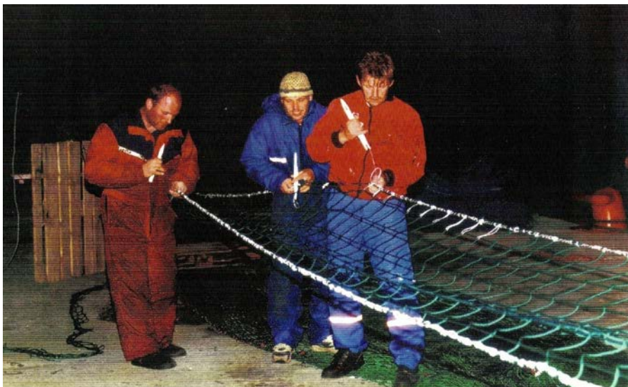
Figur 2. Produksjon av horisontalt skillepanel til montering i forlengelse på snurrevad. Mannskap på M/S "Svein Frode", Svartneshamna, september 1998.
