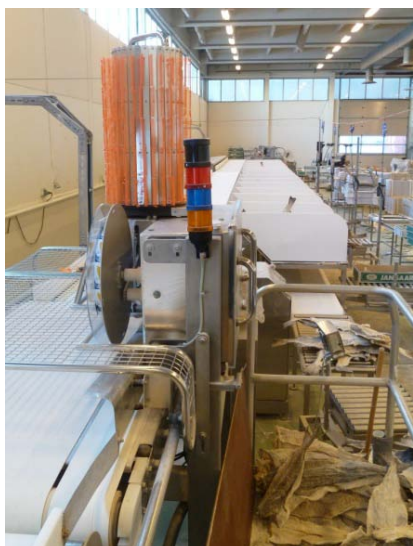
Figur 1 a og b – Pakkelinjen ved Jangaard Export AS sitt anlegg på Kleivane i Ålesund. (a) Klippfisk av godkjent tørrhet, klassifisert som 'superior' eller 'sortido', legges på båndet for automatisk veiing, merking (maskin vist midt i bildet), og sortering med hensyn på vekt i fire vektklasser; (b) Enden av prosesslinjen hvor eskene stropes før de stables på paller.
