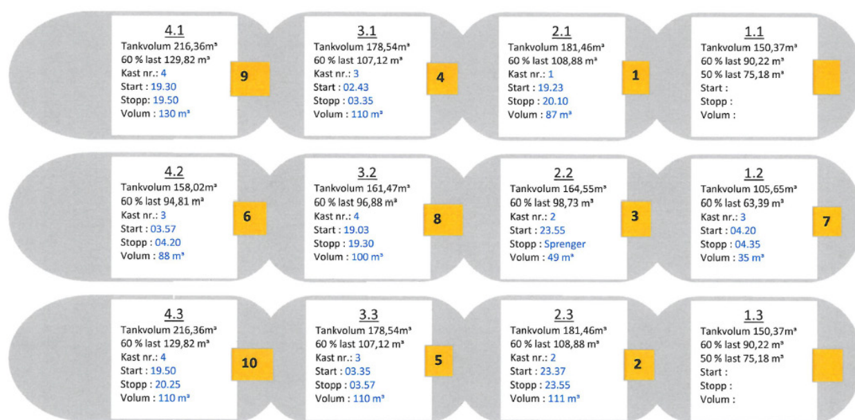
Figur 3-3: Lagringstankene om bord på M/S Christina E fylt med NVG sild under Tokt 2.
