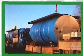
Olje- og gassfyrte kjeler fra 600 kW til 33 mW
