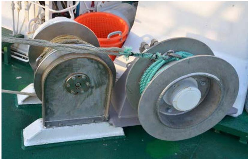
FIGUR 24. SEPARATE VINSJER FOR GEILTAU OG FLÅSNURPE.
