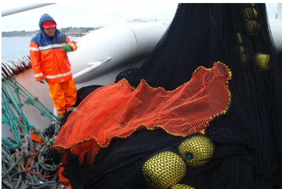
FIGUR 5. NESTE VERSJON AV "KUSTIGE KISER" BLE LAGET I RØDT NOTLIN SOM BLE ANTATT Å VÆRE LITE SYNLIG FOR FISK. TEORIEN VAR AT FISKEN SKULLE OPPFATTE PANELET SOM ET HULL I NOTA OG FORSØKE Å UNNSLIPPE. DETTE VAR IMIDLERTID IKKE TILFELLE, OG FANGSTEN VAR MINIMAL.
