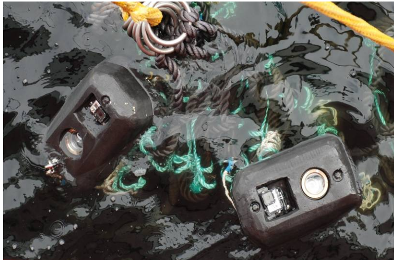
FIGUR 3. FLYTEELEMENT MED INNMONTERT KAMERA Plassert i brystpartiet på nota
