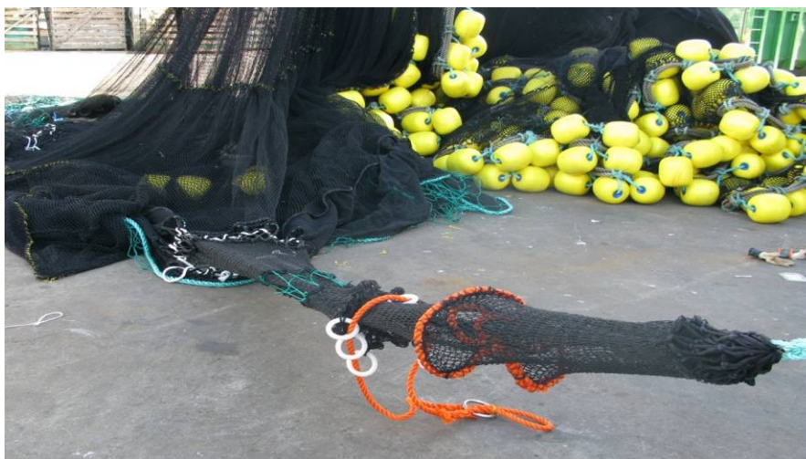
FIGUR 4. FØRSTE UTGAVE AV "KUNSTIGE KISER" VAR OPPSAMLINGSPOSER INNMONTERT I NOTVEGGEN. DET VISTE SEG IMIDLERTID AT DET VAR HØYST USIKKERT OM MAN FIKK UT EN PRØVE I DEM. DET VAR OGSÅ VANSKELIG Å FÅ TIL STOPP I KAVINGA LENGE NOK TIL Å TØMME POSENE FOR EV. FANGST.
