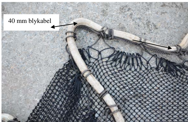
Figur 3. Tegning av enden av nota benyttet under forsøkene med geil ombord på M/S " Hillersøy".
