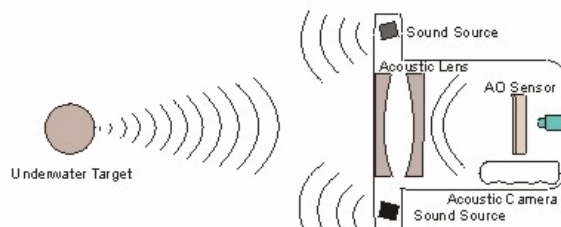
Fig. 17: Sonarbasert kamera – eksempel med akustiske linser
