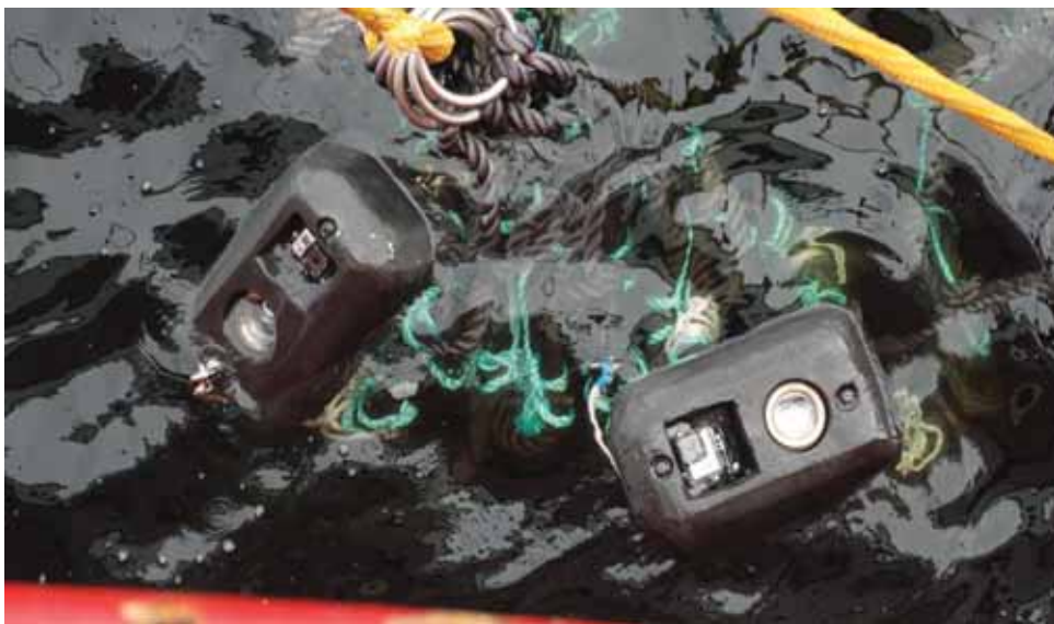
Figur 15. Flytelement med innmontert kamera plassert i brystpartiet på nota
