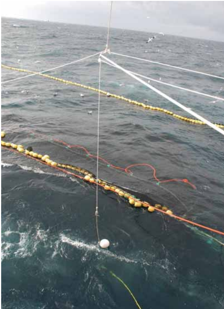
Figur 13. Kamerarigg i form av aluminiumsstang, med stag i mastetopp, til baug og rekkverk på shelterdekk. Undervannskamera henger under den hvit blåsa, og observerer mot geilåpningen. Denne riggingen ga svært urolig bilde!
