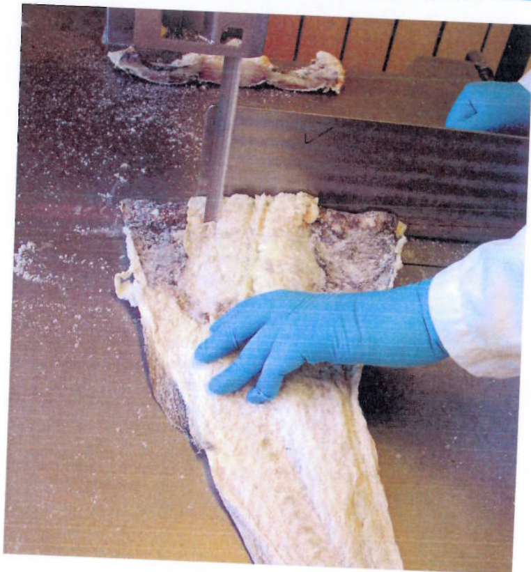
I Norge blir klippfisken skåret opp i biter og kværnet om man skal måle vanninnholdet nøyaktig. Det er en langdryg prosess som tar mange timer.
