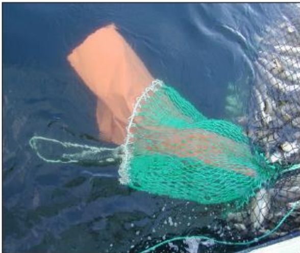
Bilde 22: Løftesekk med pressensylinder. Løftesekken er åpen i bakkant, og snørt sammen rett foran ringene til løftestroppa.
