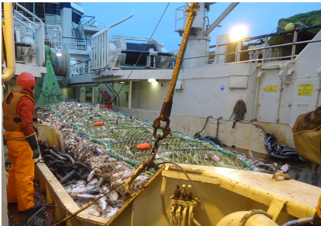
Figur 25. Sekk med Exit Windows med en fangst på ca. 21 tonn torsk under toktet med "Ramoen" i oktober 2011.
