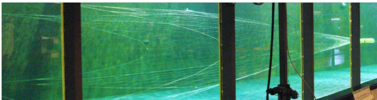
Figur 6: Oversikt over to-belg flytetral EGERSUND 720-Hex i prøvetanken.
