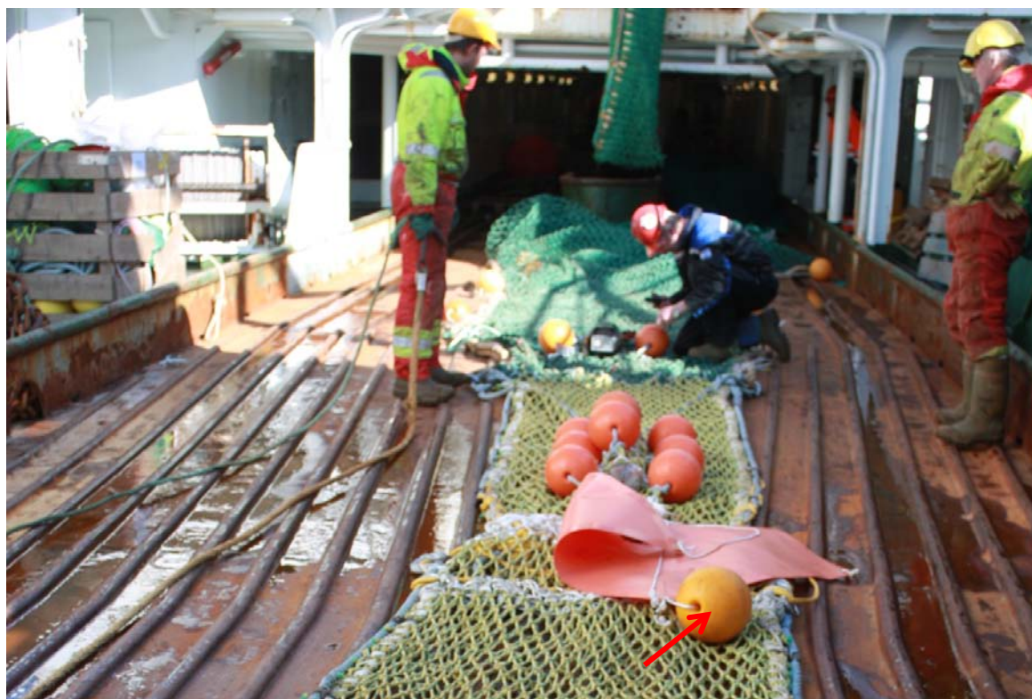
Bilde 14: Bildet viser flytekulen som ble feil festet på drivankeret: Flytekulen ble festet bak drivankeret og ikke på toppen av det.
