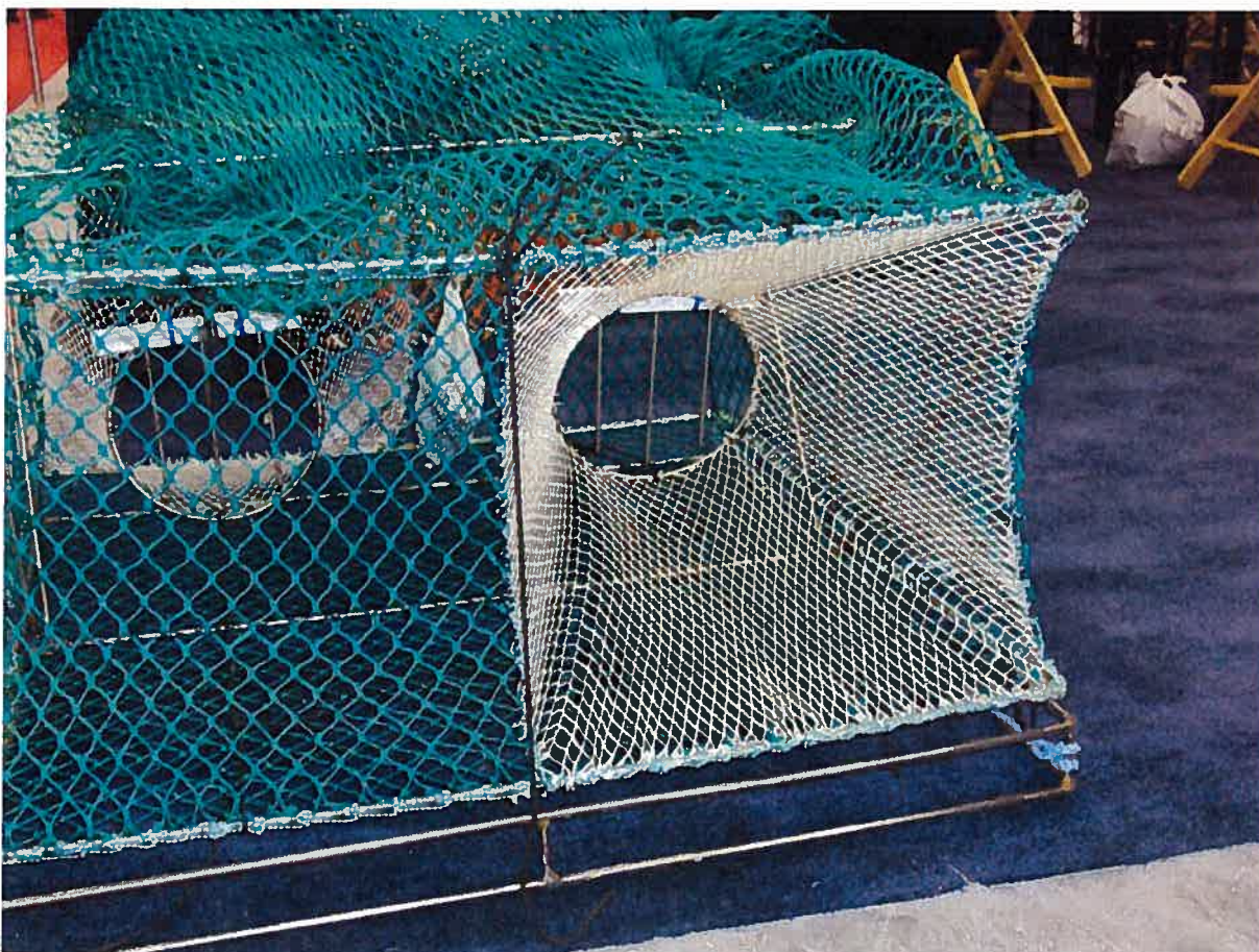
Bilde 2 Kalven er utstyrt med en enkel tilbakeholdelsesmekanisme eller fiskestopper. Denne består av metallspiler som henger ned foran ringen i kalven når den står på bunnen. Her vist på en modell (Foto: Edgar Henriksen).
