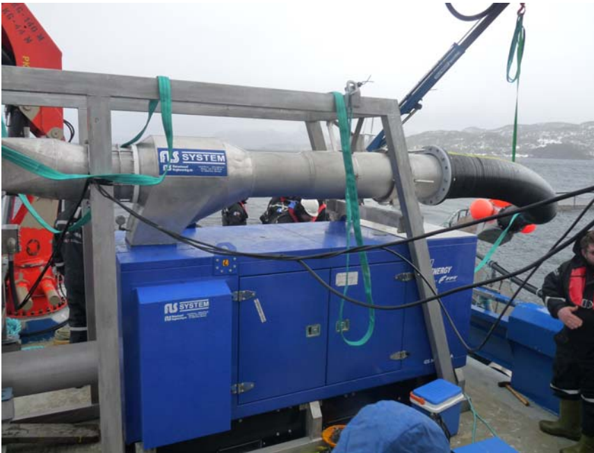
Figur 3: FLS Avlusersystem (ejektorpumpe). Det horisontale røret nederst til venstre i bildet er inntaksrør for drivvann til ejektoren. Vannet pumpes inn ved bruk en pumpe plassert i det blå skapet. Vannet går så opp til dysen fra skapet. Et undertrykk skapes dermed i ejektorsystemet som trekker vann og fisk inn i rørsystemet (øverst til venstre) (Foto: Ulf Erikson)
