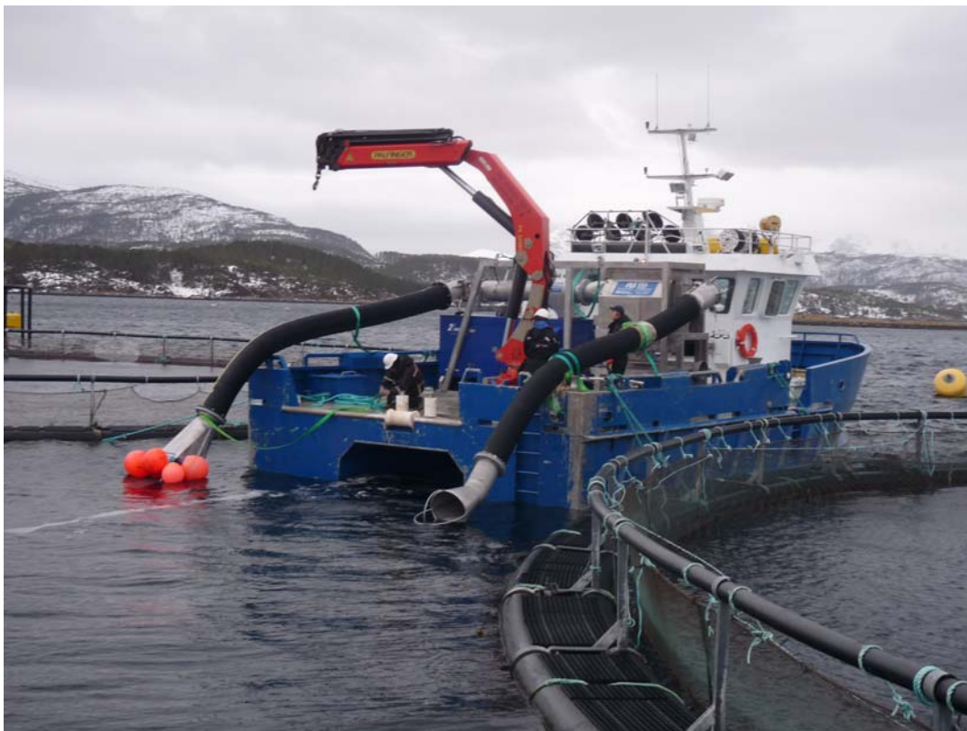
Figur 2: Ejektorpumpe for flytting og avlusing av fisk. I denne undersøkelsen ble laks til avlusing pumpet fra merden til høyre over i merden til venstre i bildet (Foto: Ulf Erikson)
