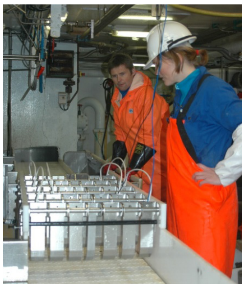
Forbedret fangstbehandling ved hjelp av elektrobedøving.
