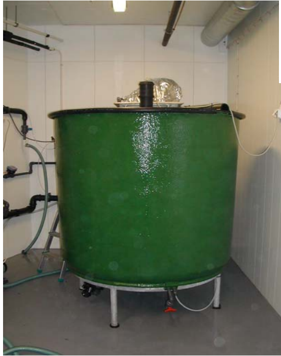
Produksjonstank (1,8m 3 ) med røktearm og utvendig lufting
