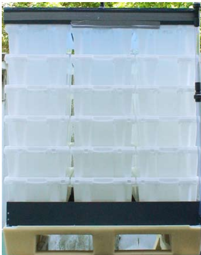
Bildet viser en transportenhet for langtids tørrtransport bestående av 21 kasser à 50 l som kan inneholde 25 kg krabber.
