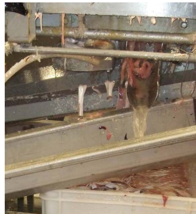
Figur 25. Detalj fra Baader fileteringsmaskin for sild som viser bukkniver, og hvor rogn faller ned fra maskinen. Noe rogn følger bukklappen ned rett etter bukkniver, og noe rogn faller ned ved renseshjul. Mage, tarmar og melke følger sammen med rogn.
