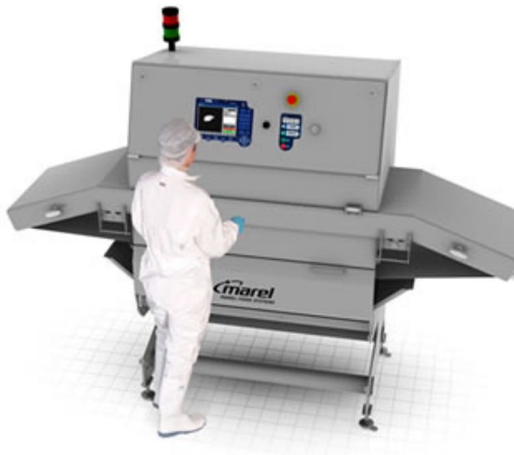
Figur 8 Marel's kommersielle maskin, SensorX, benyttes i stor grad innen kontroll av fjærkreprodukter, men var i sin tid var utviklet for påvisning av tykkfiskbein i hvitfiskfilet
