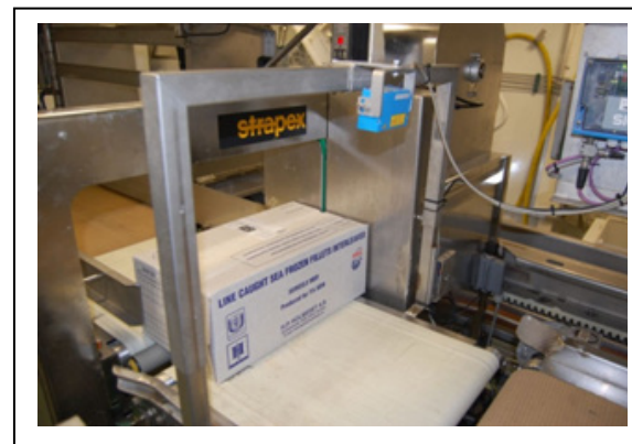
Bilde 6 Stripsing og registrering
