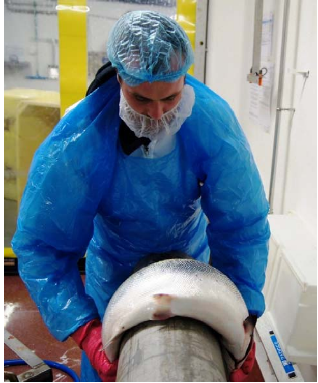
Bilde 8 og 9 Laksen ble bøyd rundt et 10 tommers stålrør på begge sider som vist på bildene.
