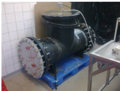
Figur 44 Vakuuumtank for uttesting av vakuuum på ubedøvd laks. Inngangen er øverst.
