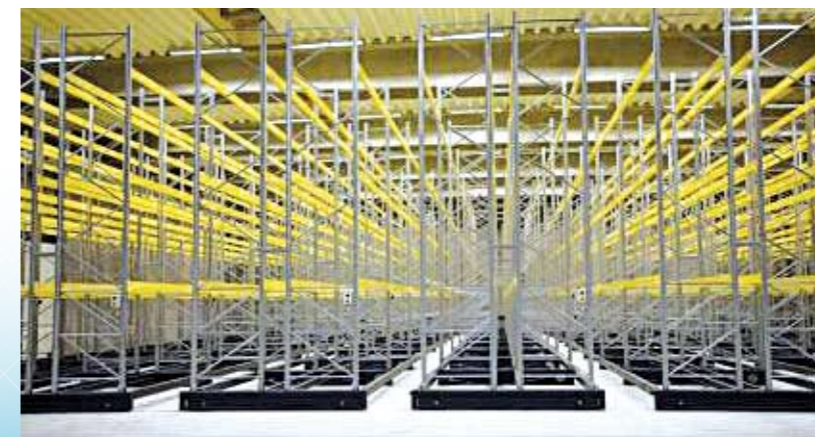
Figur 4: Mobilt reolsystem. (foto: www.hans-schourup.dk)
