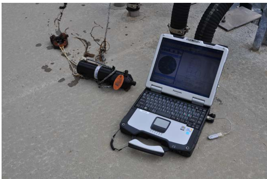
Figur 5. Lyttebøye og PC til uthenting av data frå lyttebøyen.
