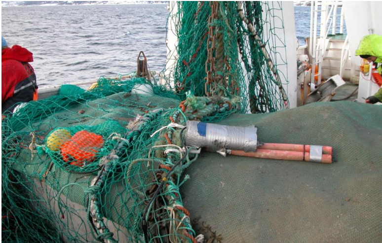
Figur 2.4.5. "Hjemmelaget" bunnkontaktsensor med vinkelcelle som viser om bunnsabb letter fra bunnen.
