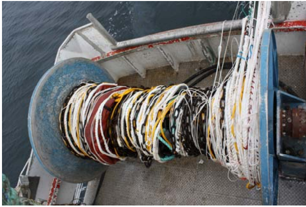
Trålsens dimensjoner må være tilpasset plass og dekkstrutning på fartøyene.
