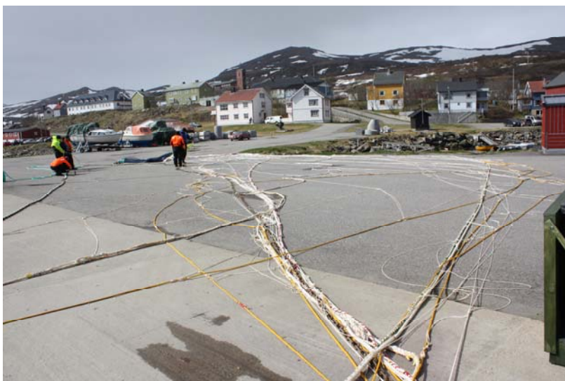
En 304 m pelagisk trål regnes som en liten trål, men den har likevel betydelig dimensjoner når den strekkes ut.
