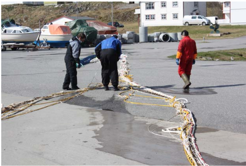
Trålen er tatt på land før bøting av brutte stolper i 8-m panelet
