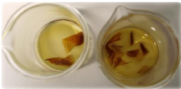
Bilde 4-14 Svarthinne i målebeger etter 15 min. i 30 % H_2O_2
