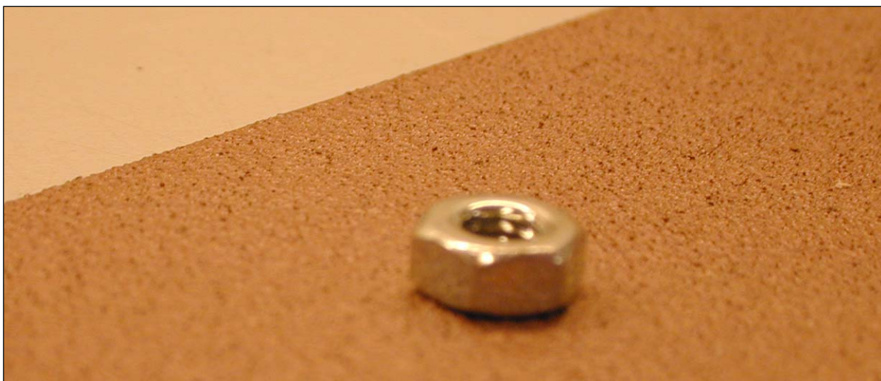
Figur 4 Permagrit verktøy bestående av metallplate med påsprøytet WC-korn. Kornstørrelsen betegnes som ”fine”.
