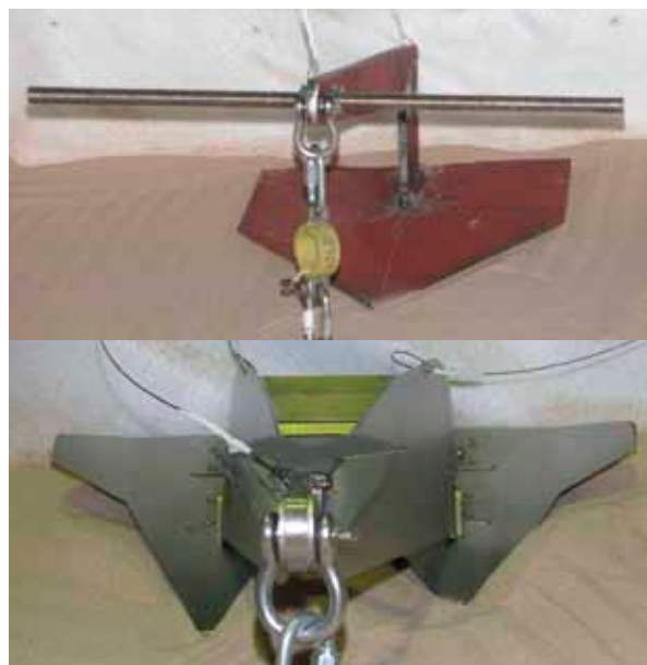
Figur 10 Modellene som ble brukt i forsøkene, ploganker øverst og Stevpris Mk5 nederst.
