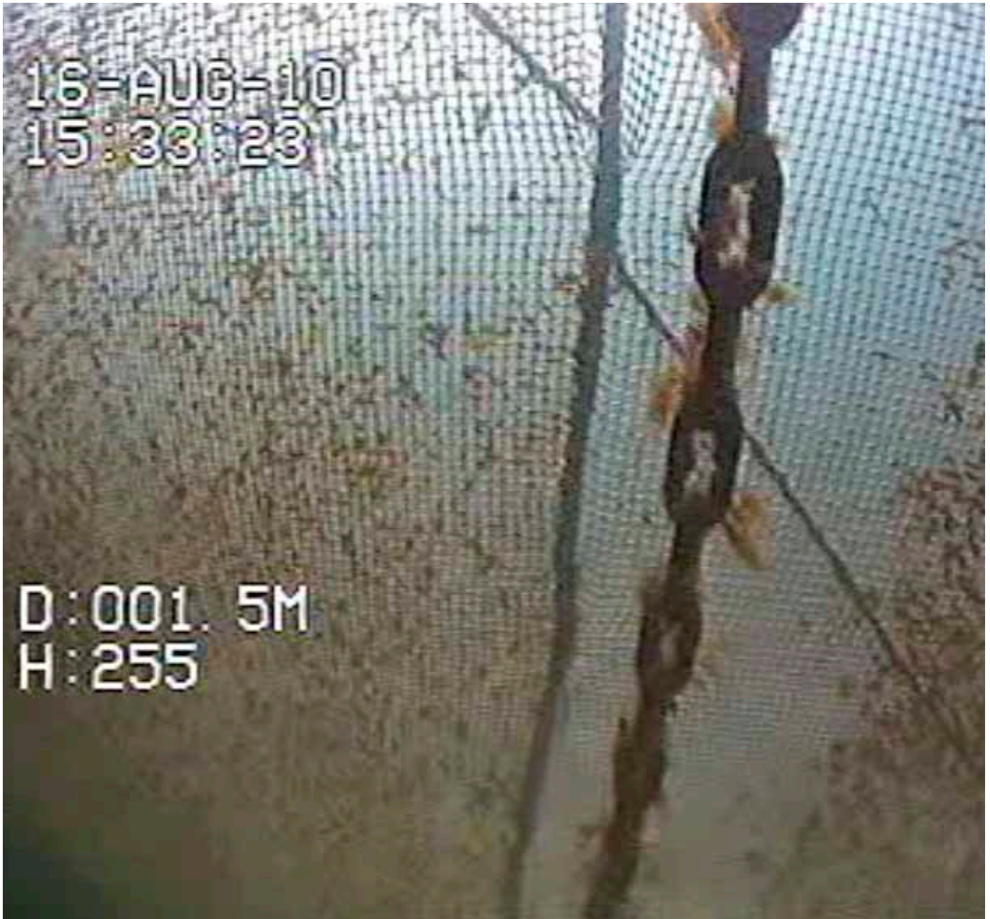
Figur 1 Not med område hvor begroing er slitt vekk (Foto fra Fiskeridirektoratet).
