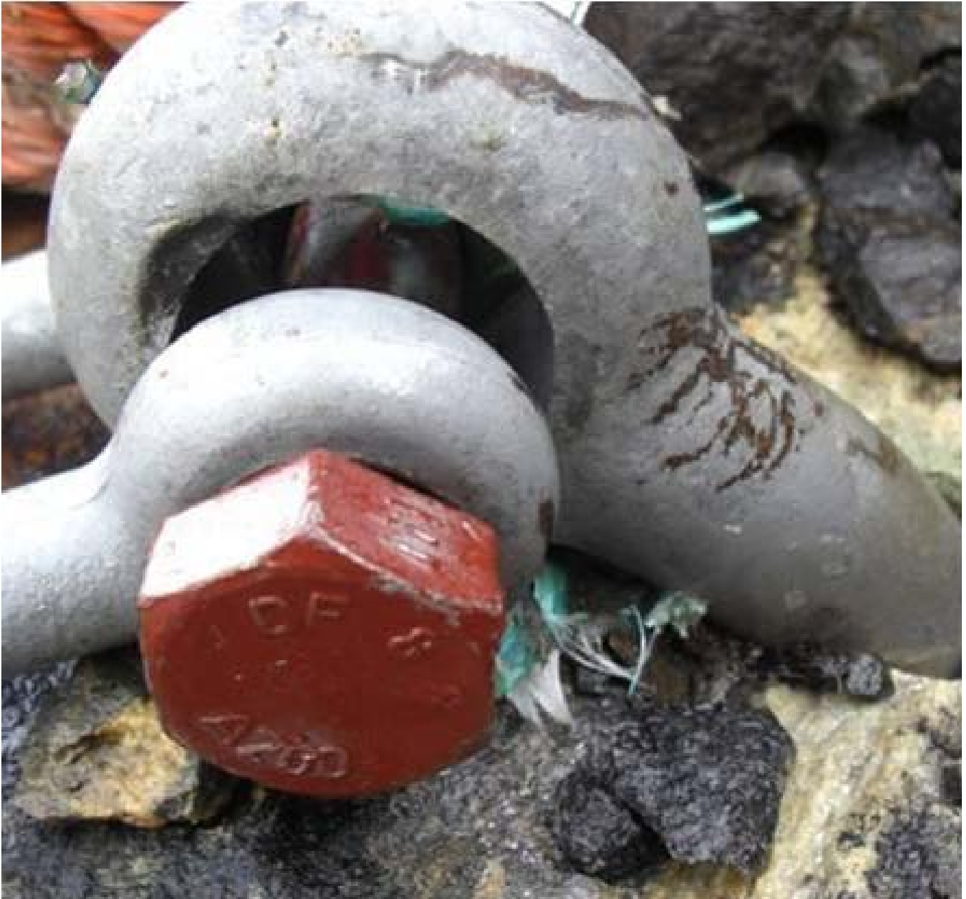
Figur 1: Bøyd fjellbolt, Foto: Noomas sertifisering
