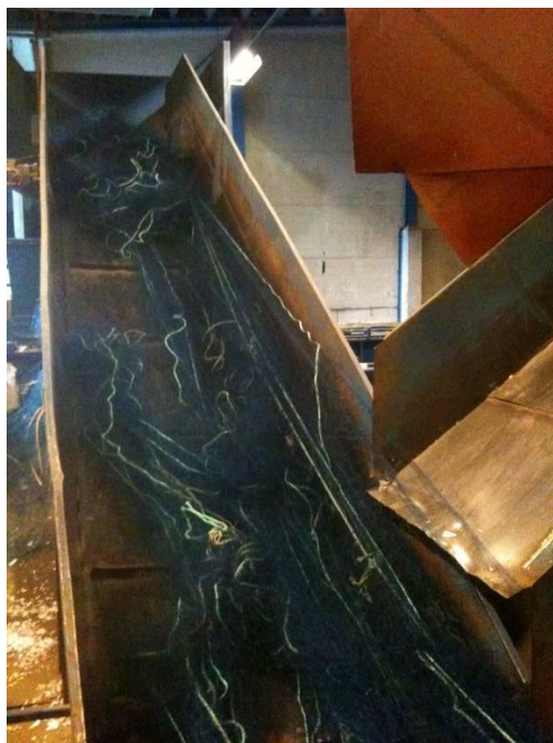
Figur 24 Garn som blir presset til baller
