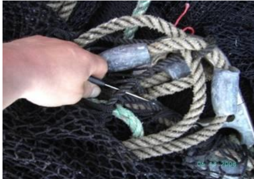
Figur 4 Kappe treningssnøret grunn
