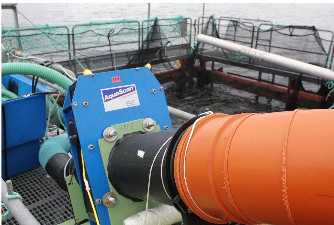
Bilde 4 Eksempel på oppsett av AquaScan under uttestingen. Hellingen skal være minimum 25 grader, og enheten skal ha lystett rørtilførsel på begge sider.
