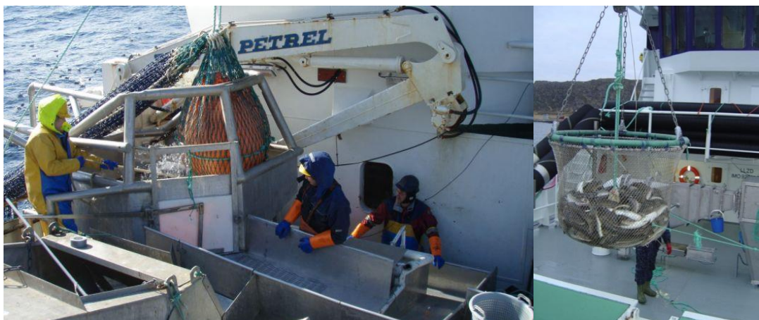
Bilde 1 Torsken tømmes fra sekken med lerretsløft i mottaksbingen og telles ned i rommet (t.v.). Rundvekt av fangsten finnes ved å veie all fisk i bomvekt i tørr håv ved levering (t.h.).
