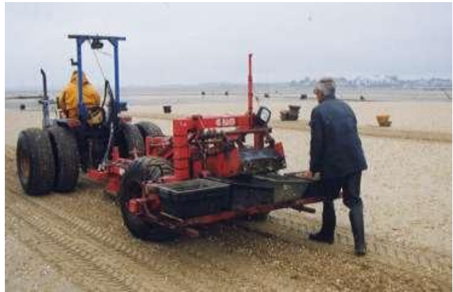
Figur 2: Traktor med rakeslede, her brukt i Storbritannia
