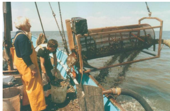
Figur 3: Mekanisk hjerteskjell høsting med sledepumpe.
