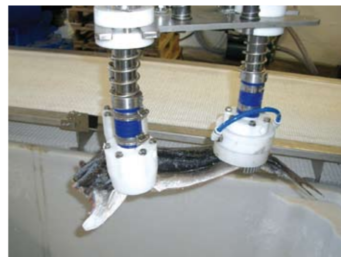
Versjon av patentert gripehode
