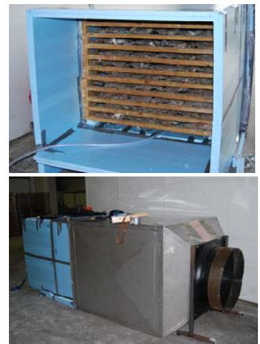
Figur 1. Arrangement og målt trykkfall avhengig av lufthastighet over vogn. Brettstørrelse: 1,0 x 1,5 m, Klosshøyde: 50mm, sei 1,0 kg, tykkelse 30 mm; 17,7 kg saltmettet fisk /brett.
