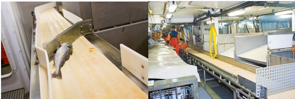
Figur 4. Til venstre ser vi transportbånd med grader, bildet til høyre viser de tre tankene fra andre siden.
