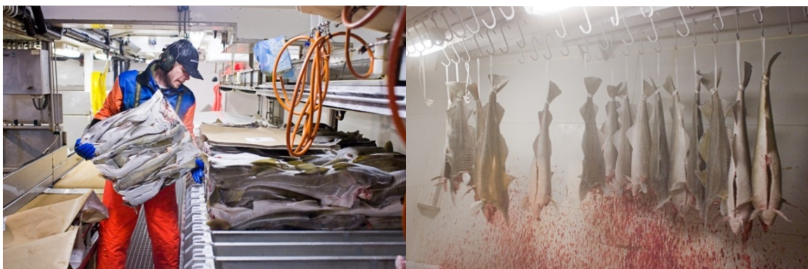
Figur 5. Til venstre ser vi tømning av fryser, fabrikkssjefen holder en halvblokk med torsk, i fryseren ses en helblokk. På bildet til høyre ser vi innfrysing av singelfisk, her fryses den hengende for å sikre rask innfrysing samt å holde på fasong.
