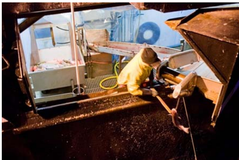
Foto 1 Islandsrull på M/S "Vonar". Foto: M. Fiskum
