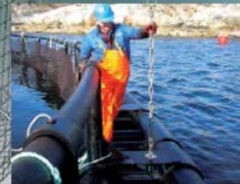
Polarcirkel Merder De fleste plastmerder er fortoyed i rammeformetning, med bunnring, fuglenettflottør, sentraføringsanlegg, kamera og sensorer. De mest populære modellene har 315, 400 og 500 mm flyterør med omkrets fra 90 – 160 meter.
