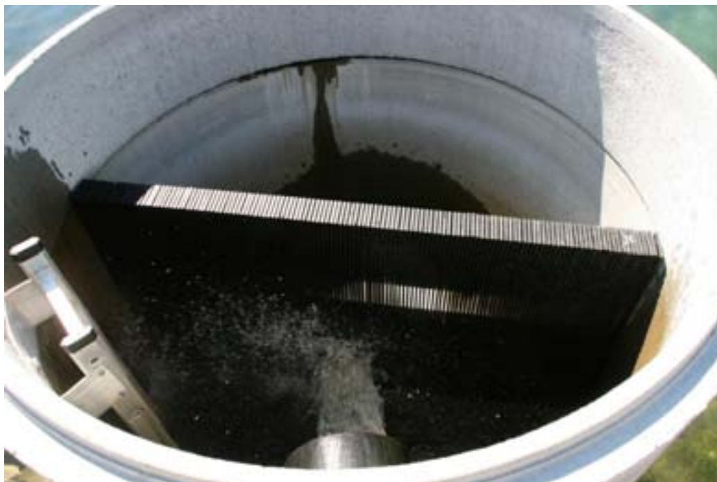
Figur 5. Akvarist som sekundærsikring på hovedavløp
