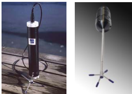
Figur 8 Vector (til v.) og ADV liknende (til h.).
