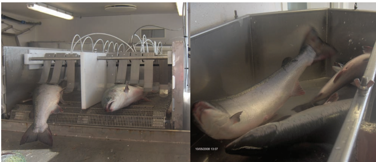
Figur 10. Bildet til venstre er tatt idet bedøvd fisk kommer ut etter elektrisk behandling, klare for bløgging. Bildet til høyre er tatt der fisk kommer inn mot bedøveren, etter avsiling. Legg merke til vinkelen ved innløpet til bedøveren, der fisken slås mot veggen.
