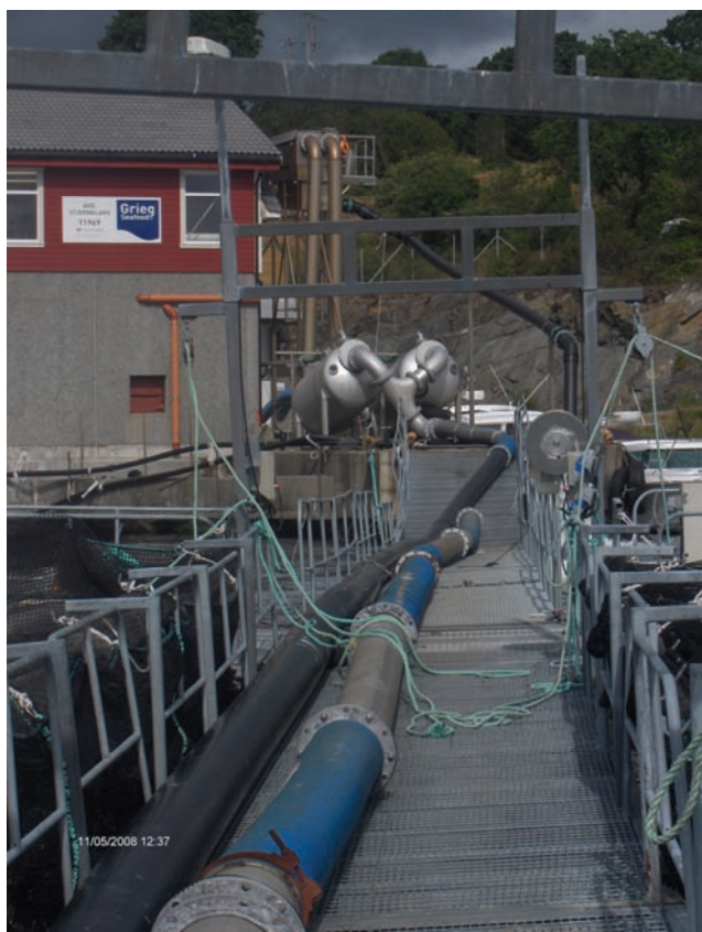
Figur 9. Bildet til venstre viser rørgate (på flytebrygge) med merder på hver side og dobbel vakuumpumpe på brygga. Fra pumpene ses rørgangene opp til avsilingskassa på utsiden av slakteriet. Bildet under viser trengning i ventemerd.
